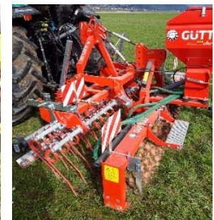
Kurz und gut: Sätstriegel am Dreipunkt erledigt alle Arbeitsschritte in einem Arbeitsgang.
