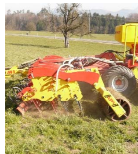
Gezogener Sätstriegel mit Ripperboard und Walze ist schlagkräftig.
