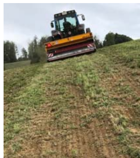
Direktsaat läuft bei Trockenheit besser auf. Enger Scharabstand ist vorteilhaft bei Weidenutzung. Verfilzte Bestände müssen aber vorgängig gestriegelt werden.
