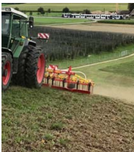
Sätstriegel entfernt den Filz und verbessert den Bodenkontakt. Im Heckanbau wird separat gewalzt. Breitsaat ist optimal für Weiden. Das Ripperboard ebnet aus.
