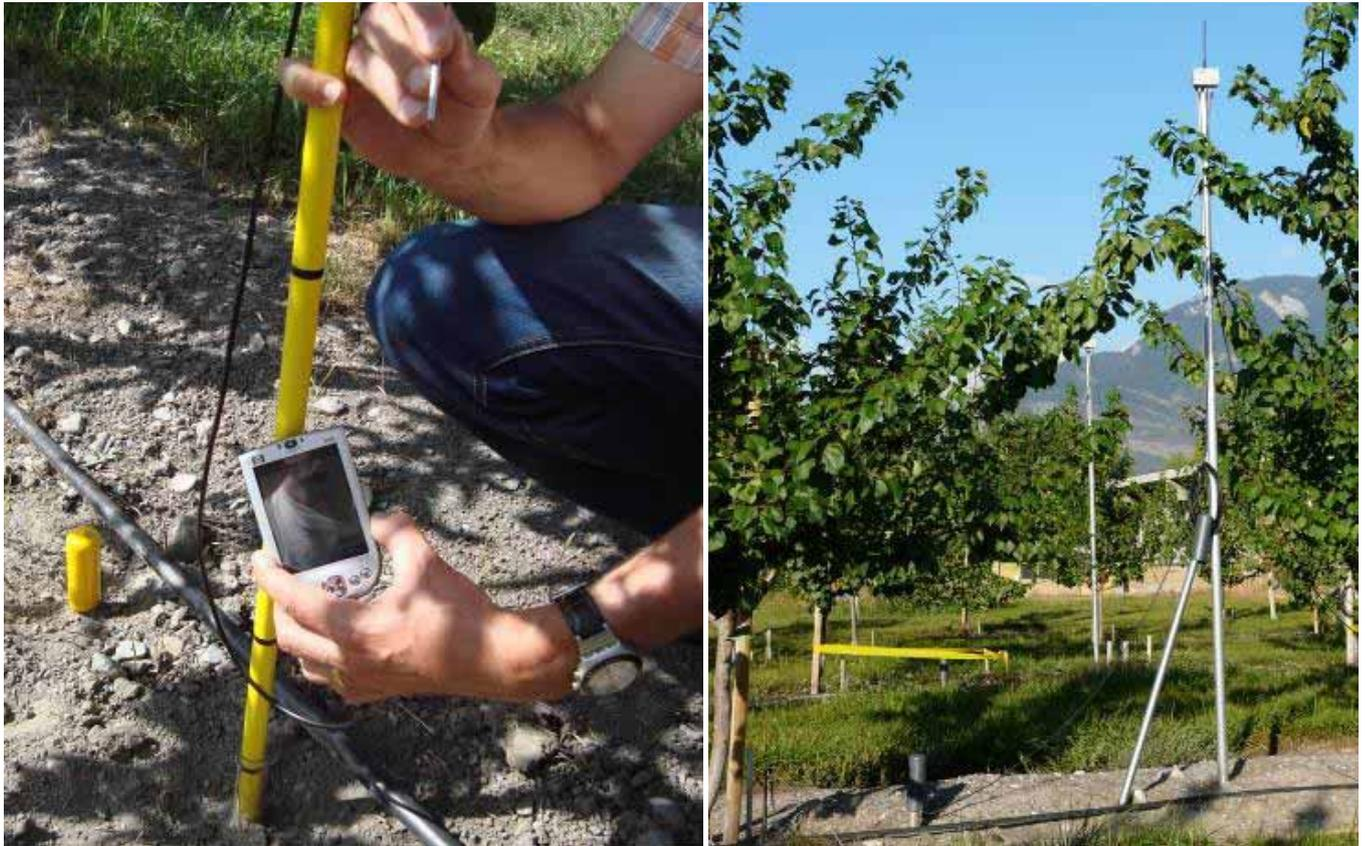
*Aquapro-sensor Sonde zur kapazitiven Messung der Bodenfeuchtigkeit (manuell).*
