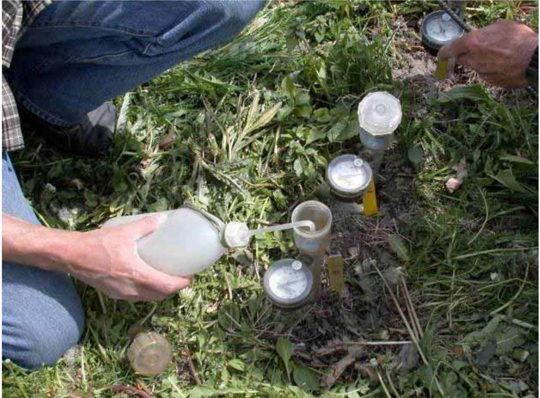
Abbildung 15: Ein paar Watermark®-Sonden, die eine Einheit bilden und die Steuerung der Bewässerung ermöglichen. Die horizontale Distanz zum Tropfer beträgt hier 30 cm mit Tiefen von 30 und 60cm.
