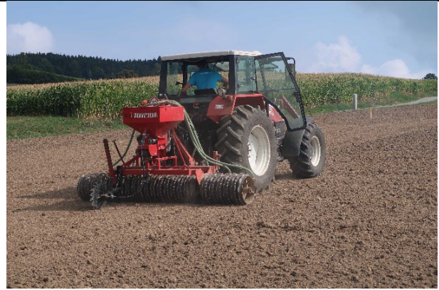
Äugsteln mit Säwalze: Die Breitsaat ergibt dichtere Grasnarbe ist aber trockenheitanfälliger als Drillsaat. Genügend Erdknollen und ein vorlaufender Striegel decken den Samen besser mit Boden und entschärfen das Problem.
