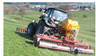
Übersaat in löwenzahnreiche Wiese mit Direktsaatmaschine.
