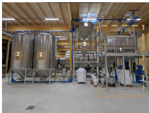
1: Reinigung 2: Lagerung 3: Absackung
