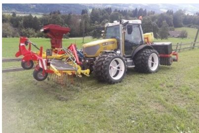
Breitsaatkombination mit Sästriegel im Frontanbau und Walze am Heck eignet sich hervorragend für Hanglagen.
