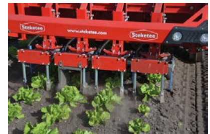
Abbildung 3: Hackroboter IC Weeder von Steketee, Quelle: https://www.dlg.org/de/landwirtschaft/themen/technik/technik-in-der-pflanzenproduktion/dlg-merkblatt-449
