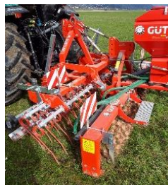
Kurz und gut - Kombination im Heckanbau: Ebnet aus, reisst Filz auf, recht den Samen ein und drückt ihn an.
