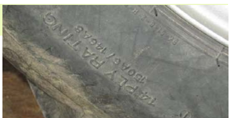
Tragfähigkeitsindex und Geschwindigkeitsindex am Reifen
