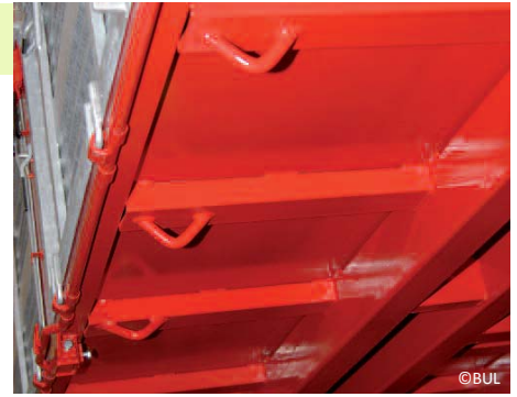
Transportanhänger müssen mit ausreichend stark dimensionierten Zurrpunkten ausgerüstet sein.
