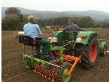
Saat mit einer 1.5m breiten Versuchs-sämaschine (Rohr 2016).
