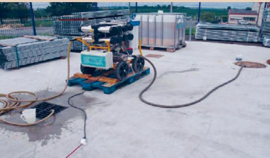
Mit der Ultrafiltrations-Anlage lassen sich grosse Waschwassermengen behandeln, CCD
