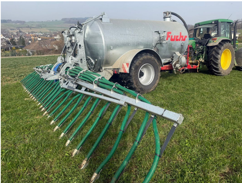
Abbildung 1: Ausbringung flüssiger Hof- und Recyclingdünger mit Schleppschuhverteiler (Quelle: LWAG)
