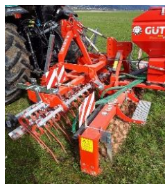
Kurz und gut - Kombination im Heckanbau: Ebnet aus, reisst Filz auf, reißt den Samen ein und drückt ihn an.
