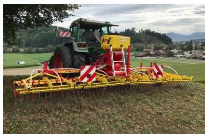
In verfilzten Beständen bewähren sich Sästriegel und Sästriegelwalzen.
