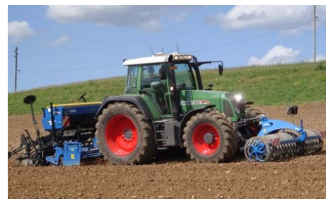
Bei Geräten mit Zapfwellenantrieb darf der Traktor „leicht“ gemacht werden. Die notwendige Frontballastierung erreicht man mit einem im Feld und auf der Strasse nützlichen Frontpacker!
