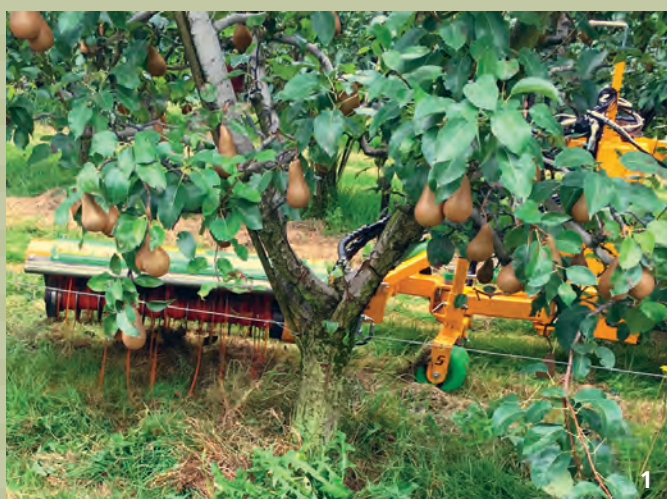
Mittels Fadengerät kann der Herbizideinsatz reduziert werden.
