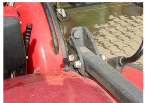
Eine Fahrerschutzvorrichtung darf nie dauerhaft, wie hier, ausser Betrieb gesetzt werden. (verschraubt = dauerhaft)
