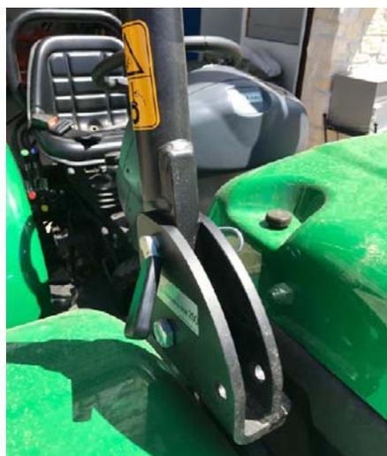
Steckbolzen, gesichert mit Splinten, erlauben die schnelle, einfache und werkzeuglose Verstellung der Fahrerschutzvorrichtung.
