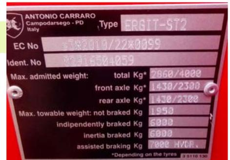
Typenschild vom Traktor mit Typenbezeichnung und Identifikationsnummer
