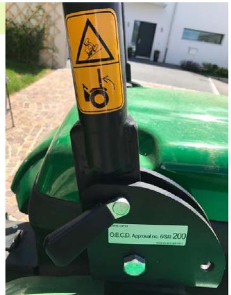
Am Klappbügel muss ein Warnhinweis angebracht sein, der auf die korrekte Stellung der Fahrerschutzvorrichtung hinweist. Zudem müssen auch die Prüfstelle und die Prüfnummer ersichtlich sein (OECD...).
