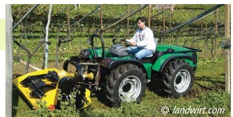
*Der Fahrerschutzbügel darf nur in dem im Antrag bezeichneten Bereich abgeklappt werden. Vor allem Schmalspurtraktoren verlangen eine besonders vorsichtige Fahrweise!*
