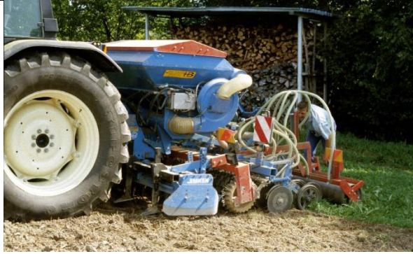
Säkombination mit Drillsaat und mehrfacher Walzarbeit (Prismenwalze, Druckrollen, Glatwalze) verspricht trockenheitunempfindliches Auflaufen.
