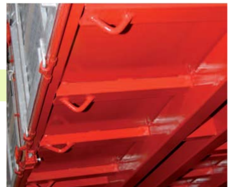
Transportanhänger müssen mit ausreichend stark dimensionierten Zurrpunkten ausgerüstet sein.
