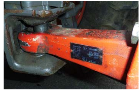
Typenschild an der Zugöse
