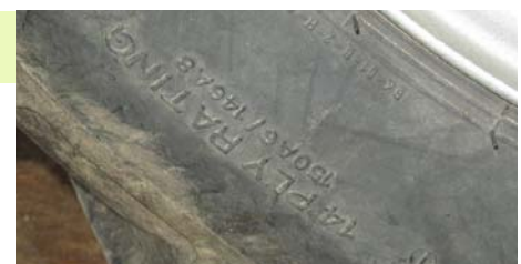
Tragfähigkeitsindex und Geschwindigkeitsindex am Reifen
