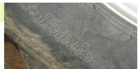
Tragfähigkeitsindex und Geschwindigkeitsindex am Reifen
