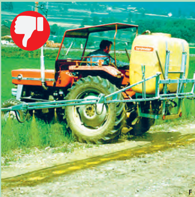
Es darf kein PSM oder mit PSM-belastetes Waschwasser auf Feldwege und Strassen gelangen!
